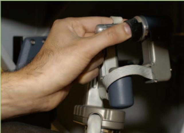
Abb. 11.3 Master Controller der chirurgischen Konsole.
